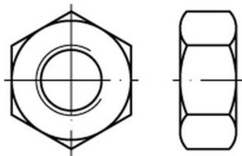
**Sechskantmutter** nach DIN 934 aus **Edelstahl A2 (Austenit)** in **Festigkeitsklasse 70** mit **metrischem Linksgewinde**. Ausführung **unveredelt** in **naturfarben** – rostbeständig, langlebig und ideal für spezielle Anwendungen, bei denen ein unbeabsichtigtes Lösen verhindert werden soll.
