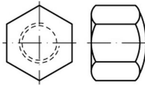
**Sechskant-Hutmuttern** nach **DIN 917** in **niedriger Form** sind kompakte Muttern mit geschlossenem **Hut**, die Schraubenenden zuverlässig abdecken und zugleich eine saubere Optik bieten. Gefertigt aus **Edelstahl A2** gewährleisten sie eine sehr gute **Korrosionsbeständigkeit** für vielfältige Anwendungen.
