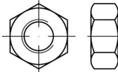
**Sechskantmuttern nach ISO 8673** sind Muttern des **ISO-Typ 1** mit **metrischem Feingewinde**. Sie ermöglichen eine **präzise Verbindung** und werden in Bereichen eingesetzt, in denen eine **hohe Sicherheit gegen Selbstblockierung** gefordert ist. In der Festigkeitsklasse 8 und mit **galvanischer Verzinkung** bieten sie sowohl eine hohe **Belastbarkeit** als auch einen wirksamen **Korrosionsschutz**. Die Norm **ISO 8673** ersetzt die ältere **DIN 934 Feingewinde**.
