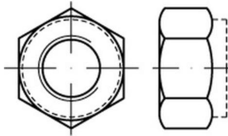
**Sechskantmuttern mit Klemmteil nach ISO 7040.** Ausführung in **Festigkeitsklasse 8**, galvanisch verzinkt, hohe Form, mit **nichtmetallischem Einsatz** für sichere Klemmwirkung. Diese Muttern sind vibrationssicher, korrosionsgeschützt und vielseitig einsetzbar.
