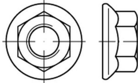
**Sechskantmuttern** nach **DIN 6923** sind Muttern mit **Flansch**, die eine vergrößerte Auflagefläche bieten und so Unterlegscheiben oft überflüssig machen. In der Festigkeitsklasse **8** und mit **galvanischer Verzinkung** ausgestattet, zeichnen sie sich durch zuverlässige **Korrosionsbeständigkeit** und hohe Belastbarkeit aus.
