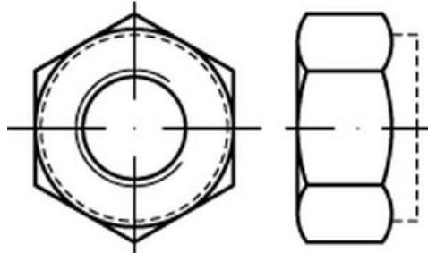
**Sechskantmuttern mit Klemmteil nach ISO 7040.** Ausführung in **hoher Form** mit **nichtmetallischem Einsatz**, bestehend aus einem **wärmestabilisierten Polyamid-Klemmring (WS)**. Oberfläche **galvanisch verzinkt** für Korrosionsschutz.
