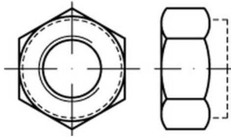
**Sechskantmuttern mit Klemmteil** nach ISO 10513, austauschbar mit der früheren DIN 6925 (Feingewinde). Ausführung als **einteilige Ganzmetall-Klemmmuttern** in Festigkeitsklasse 8, mit **metrischem Feingewinde** und **galvanischer Verzinkung** für Basis-Korrosionsschutz. Besonders geeignet für Anwendungen, die eine **präzise Vorspannung** und **vibrationssichere Verbindungen** erfordern.
