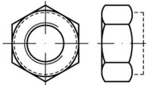
**Sechskantmuttern mit Klemmteil** nach ISO 7042, austauschbar mit der früheren DIN 6925. Ausführung als **Ganzmetall-Klemmmuttern** in Festigkeitsklasse 8, mit **flZn/TL480h-Beschichtung**. Der **Topcoat (TL)** enthält einen Schmierstoff mit Reibwert  $\mu = 0.09 - 0.14$  und sorgt für optimierte Montageeigenschaften.
