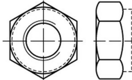
**Sechskantmuttern mit Klemmteil nach ISO 7042**, ausgeführt als **Ganzmetallmuttern** in **Festigkeitsklasse 8**. Oberfläche **feuerverzinkt** für hohen Korrosionsschutz. CE-konform: auch zur Verwendung im **Stahlbau** als nicht planmäßig vorgespannte Schraubverbindung nach **EN 15048** in Kombination mit **ISO 4014/4017 8.8 tZn SB**.
