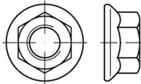
**Sechskantmuttern** nach **DIN 6923** sind Muttern mit **Flansch**, der für eine größere **Auflagefläche** sorgt und so eine gleichmäßige **Kraftverteilung** gewährleistet. Dadurch wird der Einsatz zusätzlicher Unterlegscheiben häufig überflüssig. In der Festigkeitsklasse **8** bieten sie eine zuverlässige **Belastbarkeit** für vielfältige Anwendungen. Die Norm **DIN 6923** wird heute durch die **EN 1661** ersetzt.
