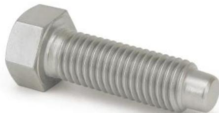
Die **DIN 561** Schraube in **Form B** (Festigkeitsklasse **8.8**) ist eine hochfeste Sechskantschraube mit **Zapfen, kleinem Sechskant** und **Gewindeauslauf** für präzise, normgerechte Verschraubungen. Die **unveredelte, naturfarbene Oberfläche** eignet sich besonders für **trockene Innenbereiche** oder Bauteile, die später **beschichtet** bzw. **veredelt** werden.
