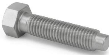
Die **DIN 561** Schraube in **Form A** (Festigkeitsklasse **8.8**) ist eine hochfeste Sechskantschraube mit **Zapfen**, **kleinem Sechskant** und **Rille (Ri)** für präzise, normgerechte Verschraubungen. Die **unveredelte, naturfarbene Oberfläche** eignet sich besonders für **trockene Einsatzbereiche** oder Bauteile, die später **beschichtet** bzw. **veredelt** werden.
