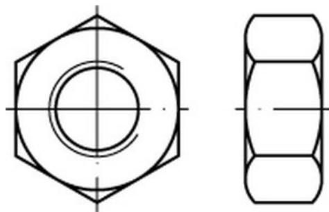
**Sechskantmutter** nach DIN 934 aus **6/6 Automatenstahl** mit **unveredelter, naturfarbener Oberfläche**. Ausführung mit zölligem **Whitworth-Regelgewinde (BSW)** – präzise gefertigt für Anwendungen im Maschinenbau und bei Reparaturen von britischen oder älteren Anlagen.
