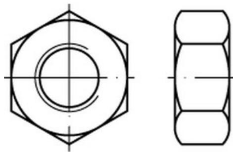
**Sechskantmuttern nach DIN 934 mit metrischem Links-Feingewinde**
