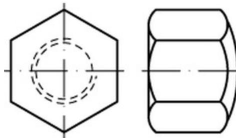
**Sechskant-Hutmuttern** nach **DIN 917** in **niedriger Form** sind platzsparende Muttern mit geschlossenem **Hut**, die das Schraubenende abdecken und gleichzeitig eine saubere Optik sicherstellen. In der Ausführung aus **Stahl 6** bieten sie eine solide Lösung für vielfältige Anwendungen.
