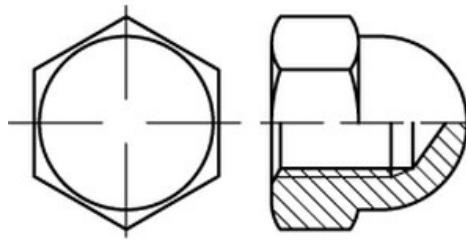
**Sechskant-Hutmuttern** nach **DIN 1587** in **hoher Form**, **Festigkeitsklasse 6**, mit **metrischem Feingewinde**. Diese Muttern schützen das Schraubenende und sorgen für ein sauberes Erscheinungsbild.
