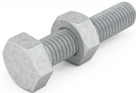
Sechskantschrauben nach **ISO 4017** in Festigkeitsklasse **5.6** mit Gewinde bis zum Kopf, geliefert zusammen mit passender **Sechskantmutter nach ISO 4032/5**. Die Verbindungselemente sind **feuerverzinkt**, was für einen hohen Korrosionsschutz sorgt und sie besonders für den Einsatz im Außenbereich und in feuchten Umgebungen prädestiniert. Die Ausführung **AD W7** ist TRD-zugelassen und damit für Druckgeräte und ähnliche sicherheitsrelevante Anwendungen geeignet.
