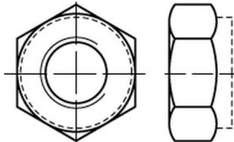
DIN 980 10 Form V flZn/TL 480h (zinklamellenbesch.) Sechskantmuttern mit Klemmteil, Ganzmetallmuttern, einteilig
