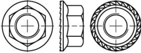
~DIN 6923 10 Sperrzahn galvanisch verzinkt Sechskantmuttern mit Sperrverzahnung und Flansch
