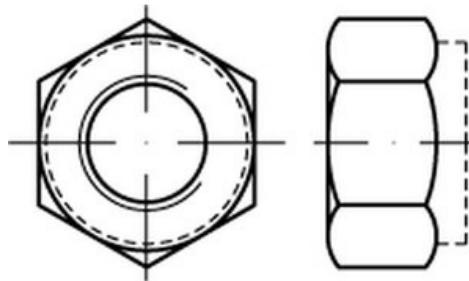
**Sechskantmuttern mit Klemmteil nach ISO 6924.** Ausführung in **Festigkeitsklasse 10**, galvanisch verzinkt, hohe Form, mit **nichtmetallischem Einsatz** und **metrischem Feingewinde** für präzise und sichere Klemmwirkung. Besonders geeignet für Anwendungen, die **hohe Festigkeit** und **genaue Einstellbarkeit** erfordern.
