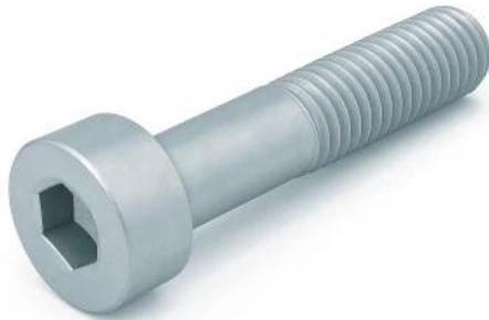
Unsere **Zylinderschrauben mit Innensechskant** nach ISO 6912 (niedriger Kopf, mit Schlüsselführung) in der **Festigkeitsklasse 10.9** sind **galvanisch verzinkt** und zusätzlich **getempert**.
