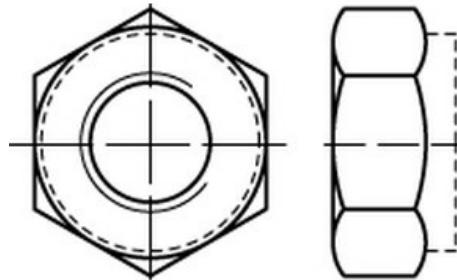
**Sechskantmuttern mit Klemmteil nach ISO 7042.** Ausführung als **Ganzmetall-Klemmmuttern** in **Festigkeitsklasse 10**, mit **galvanischer Verzinkung** für Basis-Korrosionsschutz. Diese Muttern sind vibrationssicher, hochfest und für anspruchsvolle Schraubverbindungen geeignet.
