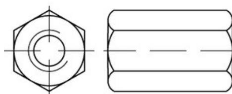
**Sechskantmuttern nach DIN 6334** sind **lange Muttern** mit einer Höhe von **3d**, die auch als **Muffen** bezeichnet werden. Sie werden bevorzugt eingesetzt, um **Gewindestangen** oder Schrauben zu verlängern bzw. sicher miteinander zu verbinden. In der Festigkeitsklasse **10** und mit **galvanischer Verzinkung** bieten sie eine hohe **Belastbarkeit** und zusätzlichen **Korrosionsschutz**. Ergänzend sind unter den Artikelnummern **88088** und **88087** runde und sechskantige Muffen verfügbar.
