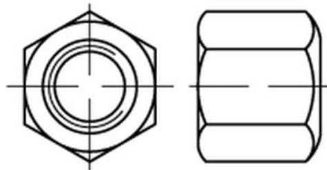
**Sechskantmuttern** nach **DIN 6330** sind **schwere Muttern** mit einer Höhe von **1,5 d**. In der Ausführung **Form B** verfügen sie über eine **kugelige und ebene Auflagefläche**, die eine optimale **Kraftübertragung** sowie eine sichere Verbindung gewährleistet. Durch die **galvanische Verzinkung** wird ein zuverlässiger **Korrosionsschutz** erzielt. In der Festigkeitsklasse **10** sind sie besonders für anspruchsvolle Anwendungen im **Maschinenbau** und **Stahlbau** geeignet.
