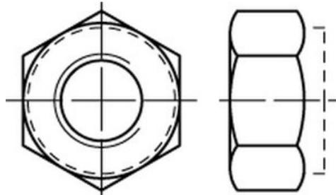
**Sechskantmuttern mit Klemmteil nach ISO 10512.** Ausführung in Festigkeitsklasse 10, galvanisch verzinkt, hohe Form, mit **nichtmetallischem Einsatz** und **metrischem Feingewinde** für sichere und präzise Klemmwirkung.
