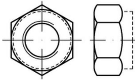
**Sechskantmuttern mit Klemmteil nach ISO 7042**, austauschbar mit der früheren DIN 6925 (Regelgewinde). Ausführung als **Ganzmetall-Klemmmuttern** in Festigkeitsklasse 10, mit **galvanischer Verzinkung** für soliden Korrosionsschutz. Diese Muttern sind vibrationssicher und für hochbelastete Schraubverbindungen geeignet.
