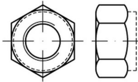
**Sechskantmuttern mit Klemmteil nach ISO 7040.** Ausführung in **Festigkeitsklasse 10**, galvanisch verzinkt, hohe Form, mit **nichtmetallischem Einsatz** für sichere Klemmwirkung. Diese Muttern sind vibrationssicher, hochfest und für anspruchsvolle Schraubverbindungen geeignet.
