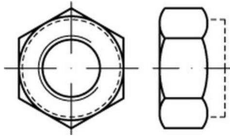
**Sechskantmuttern mit Klemmteil nach ISO 10513**, austauschbar mit der früheren DIN 6925 (Feingewinde). Ausführung als **einteilige Ganzmetall-Klemmmuttern** in Festigkeitsklasse 10, mit **metrischem Feingewinde** und **galvanischer Verzinkung** für soliden Korrosionsschutz. Besonders geeignet für Anwendungen, die eine **präzise Vorspannung** und **höhere Festigkeit** erfordern.
