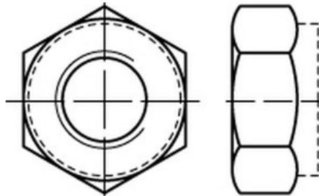
**Sechskantmuttern mit Klemmteil nach ISO 7042.** Ausführung als **Ganzmetall-Klemmmuttern** in **Festigkeitsklasse 10**, mit **fIzn/TL480h-Beschichtung**.
