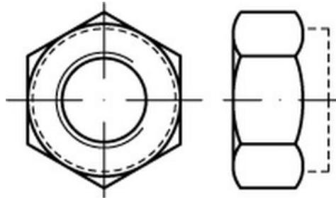
**Sechskantmuttern mit Klemmteil** nach ISO 7042, austauschbar mit der früheren DIN 6925. Ausführung als **Ganzmetall-Klemmmuttern** in Festigkeitsklasse 10, mit **fZn/TL480h-Beschichtung**. Der **Topcoat (TL)** enthält einen Schmierstoff mit Reibwert  $\mu = 0.09 - 0.14$  und sorgt für kontrollierte Vorspannkräfte bei der Montage.
