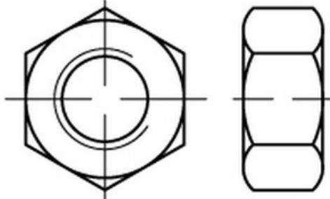
**ISO 4032 10.9 flZnL 480h** – Hochfeste **Sechskantmuttern** mit **Zinklamellenbeschichtung**, ISO-Typ 1. Diese Muttern bieten durch die innovative **Oberflächenbehandlung flZnL** (mit integriertem Schmierstoff) eine verbesserte Reibungs- und Korrosionsbeständigkeit.
