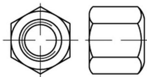
Sechskantmuttern nach DIN 6330 sind **schwere Muttern** mit einer Höhe von **1,5 d**. In der Ausführung **Form B** verfügen sie über eine **kugelige und ebene Auflagefläche**, wodurch eine gleichmäßige Kraftübertragung und sichere Verbindung gewährleistet wird. In der Festigkeitsklasse **10** bieten sie eine hohe **Belastbarkeit** für anspruchsvolle Anwendungen im Maschinen- und Stahlbau.
