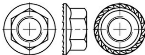
**Sechskantmuttern nach DIN 6923** sind Muttern mit **Flansch** und integrierter **Sperrverzahnung**. Durch diese Verzahnung wird ein selbsttägiges Lösen der Verbindung verhindert, was sie ideal für Anwendungen mit **Vibration** oder **hohen Belastungen** macht. In der Festigkeitsklasse **10** bieten sie eine besonders hohe **Tragfähigkeit**.
