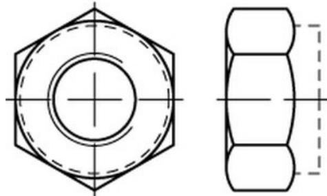
**Sechskantmuttern mit Klemmteil nach ISO 10511.** Ausführung in **Festigkeitsklasse 05**, galvanisch verzinkt, niedrige Form, mit **nichtmetallischem Einsatz** für sichere und dauerhafte Klemmwirkung. Diese Muttern sind vibrationssicher, bieten Basis-Korrosionsschutz und werden im Maschinen- und Leichtbau vielfach eingesetzt.
