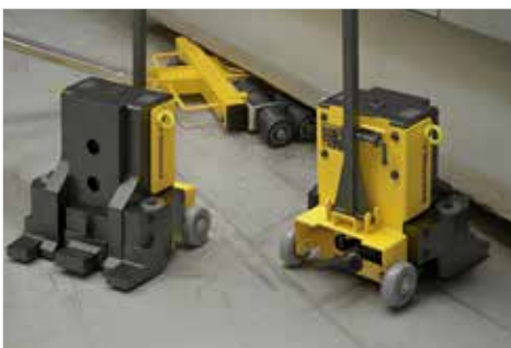
◀ Anheben von Maschinen mit Maschinenhebern und horizontaler Transport mit den Wälzwagen auf Rädern der MLS-Serie.
