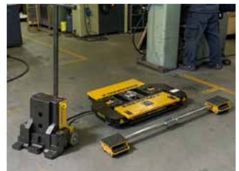
▼ Anheben von Maschinen mit Maschinenhebern und horizontaler Transport mit akkubetriebenen Wälzwagen der EMLS-Serie.
