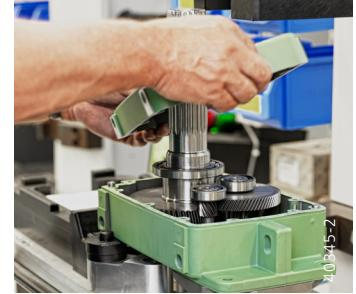
Das Getriebe des DC-II ist weiterhin ein Eigenbau von Demag. Nur so können wir unserem Anspruch an die Qualität des Kettenzugs gerecht werden.
