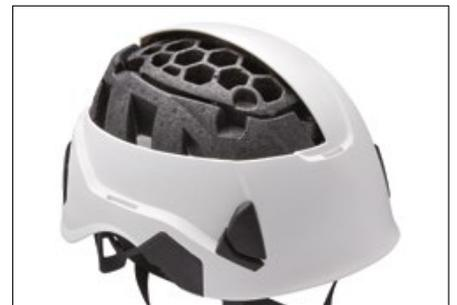
Die Innenschale der STRATO-Helme besteht aus zwei Teilen: EPP (expandiertes Polypropylen) und EPS (expandiertes Polystyrol), um das Gewicht zu reduzieren. Stöße und Schläge werden durch Verformung der Innenschale absorbiert.
