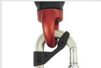
Die ovale symmetrische Form ermöglicht es, den Karabiner bei der Einrichtung von Anschlagpunkten optimal zu positionieren. Die Verwendung des Karabiners mit dem CAPTIV-Positionierungsbügel ermöglicht es, die Belastung des Karabiners in der Längsachse zu favorisieren, ein Verdrehen des Karabiners zu verhindern und zu gewährleisten, dass er eine feste Einheit mit dem Gerät bildet.
