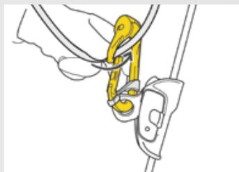
Der ROLLCLIP A-Karabiner mit Seilrolle kann in Kombination mit der Seilklemme RESCUCENDER in einem Flaschenzug als Umlenkung verwendet werden.
