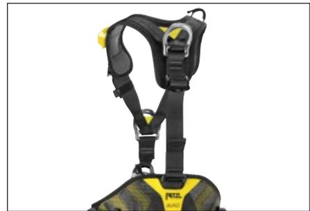
Die Komplettgurte AVAO BOD und AVAO BOD FAST sind mit einer dorsalen Öse zum Einhängen eines Auffangsystems ausgestattet. Im Falle eines Sturzes in diese Öse wird bei kurz eingestellter Länge der Verbindung zwischen Hüftgurt und Beinschlaufen das Gewicht auf die Beinschlaufen verteilt, so dass der Anwender problemlos im Gurt hängen kann, während er auf die Rettung wartet.
