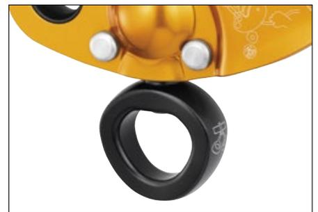
Die untere Verbindungsöse mit einem Wirbel mit hohem Wirkungsgrad gewährleistet die richtige Positionierung des mechanischen Prusik und eine optimale Seilführung im Gerät.
