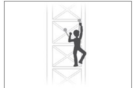
Die zweisträngigen ABSORBICA-Y-Verbindungsmitel ermöglichen es, beim Passieren von Zwischensicherungen durch Aus- und Einhängen der beiden Stränge nacheinander permanent gesichert zu bleiben.
