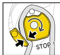
Nach der Blockierung kann ohne Betätigung des Hebels Seil eingezogen werden.
