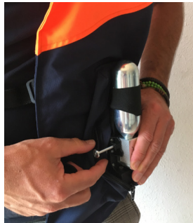
Sicherungsstift reinschieben und Flexband und Gasflasche legen.
