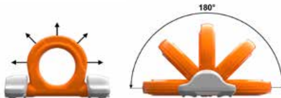
Bild 1: erlaubte Belastungsrichtungen die bei bestimmungsgemäßigem Gebrauch auftreten können.
