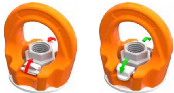
Bild 8: Stellung „A“. Beide Sperren berühren die Mutter. Nur bei Montage und Demontage zulässig
