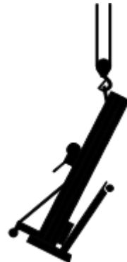
Schieben Sie den Hubhaken immer so durch die Huböse, dass er von der Maschine weg zeigt.
