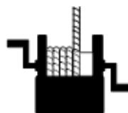
Verwenden Sie die Maschine nicht, wenn sich bei voll abgesenktem Schlitten weniger als vier Kabelwicklungen auf der Trommel der Winde befinden.
