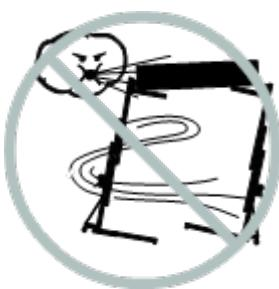
Bei starkem Wind darf die Last nur dann angehoben bleiben, wenn die Maschine ausreichend mit einem Halteseil gesichert ist.
