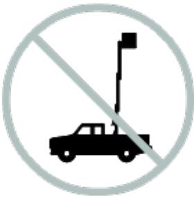
Die Maschine darf nicht auf einer beweglichen oder mobilen Fläche oder auf einem Fahrzeug eingesetzt werden.
