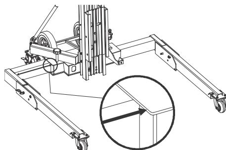
Der Abstand zwischen dem verstellbaren Arm und der Kante des verstellbaren Unterbaus darf 13,75 in oder 35 cm nicht überschreiten.
