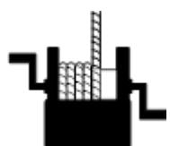
Verwenden Sie die Maschine nicht, wenn sich bei voll abgesenktem Schlitten weniger als vier Kabelwicklungen auf der Trommel der Winde befinden.
