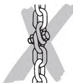
Het apparaat zelf nooit als aanslagmiddel gebruiken voor kabels, kettingen of stroppen.
