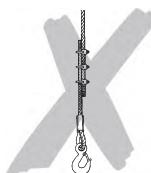
Ne pas faire de nœud avec la chaîne, ni fixer l'appareil au moyen de boulon, vis, tournevis ou similaire. Les chaînes assemblées de manière permanente dans l'appareil de levage ne doivent pas être réparées. Ne pas tirer la chaîne sur des arêtes.
