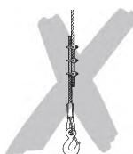
No se deben hacer nudos en la cadena para enganchar la pinza ya sea con pernos, tornillos, destornilladores o herramientas similares. La cadena de la pinza no debe ser reparado. Evitar el roce entre la cadena y cantos vivos.
