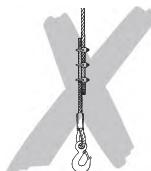
Geen knopen in de aanslagketting leggen of deze verbinden met kabelklemmen, schroeven en dergelijke (afb. 5). Kettingen die vast in het hijshulpmiddel gemonteerd zijn mogen niet worden gerepareerd. Trek de ketting niet over de randen.
