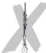
Kette zum Anschlagen des Gerätes nicht knoten oder mit Bolzen, Schraube, Schraubendreher oder Ähnlichem verbinden. Fest in Lastaufnahmemittel eingebaute Ketten dürfen nicht instand gesetzt werden. Die Kette nicht über Kanten ziehen.
