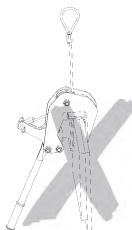
Die Belastung des Lastaufnahmemittels mit seitlichen Zugkräften ist verboten.
