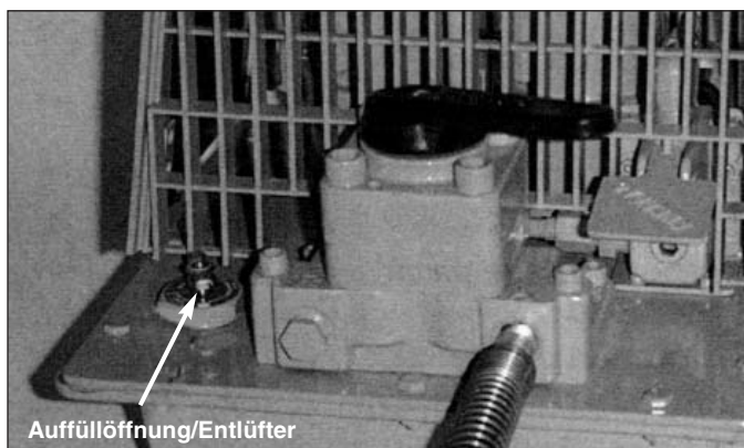
Abbildung 2 - Position des Entlüfter-/Füllstopfens
