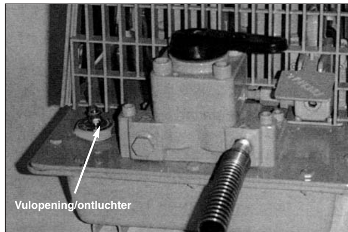
Afbeelding 2 - Locatie van de ontluuchtings-/vuldop
