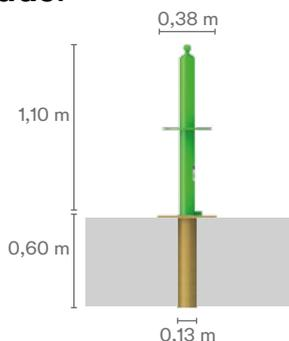
Hülse zur fixen Montage in Beton **8530872**
