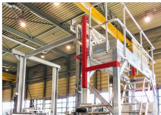
Arbeitsbühne mit faltbarem Geländerkäfig mit innenliegendem Aufstieg
