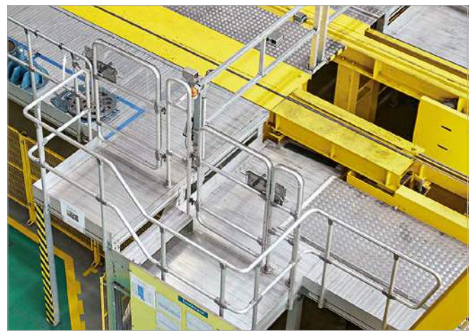
Arbeits- und Wartungsbühne als Prüfstand
