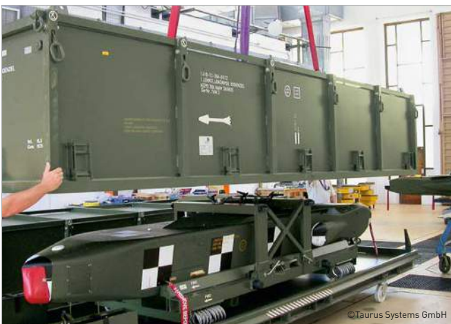
Schockabsorbierende Behälter für den Transport von Flugkörpern
