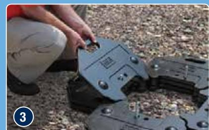
③ Stapeln Sie die Platten (Gewichte) über die Bolzen auf den gummierten Platten
